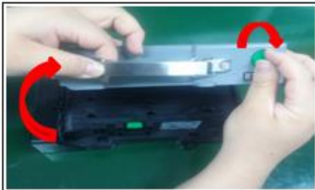
Open door using RT KNOB.
