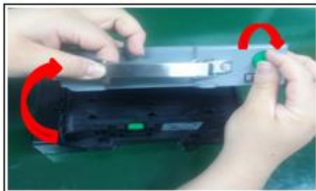
Open door using RT KNOB.
