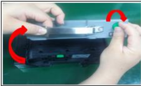
Open door using RT KNOB.
